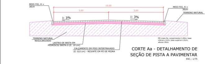
CORTE Aa - DETALHAMENTO DE SEÇÃO DE PISTA A PAVIMENTAR
